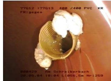
einragend, falsches Material
