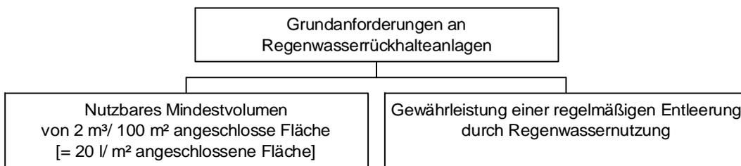
Bild 2: Grundanforderungen an Regenwasserrückhalteinlagen
