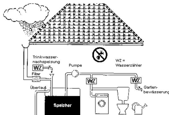
Bild 3: Prinzipieller Aufbau einer Regenwassernutzungsanlage
